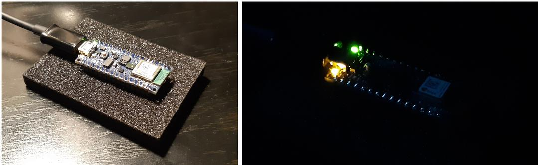
FIGURE 14 – Allumage de la LED sur la carte Arduino Nano BLE 33
