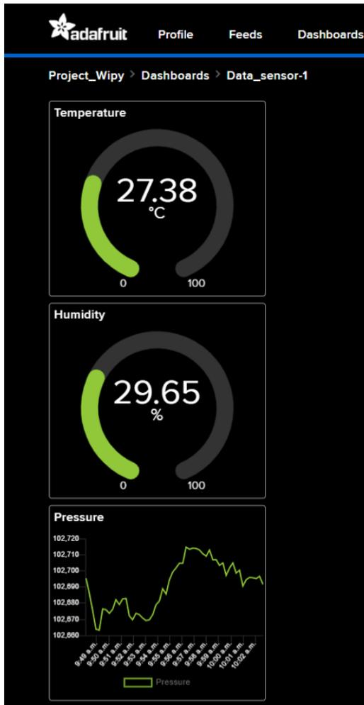
FIGURE 6 – Résultat d’affichage des données sur Adafruit IO pour la carte Wipy 1
