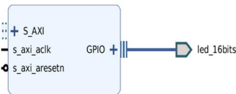
FIGURE 7 – Bloc GPIO pour les LEDs
