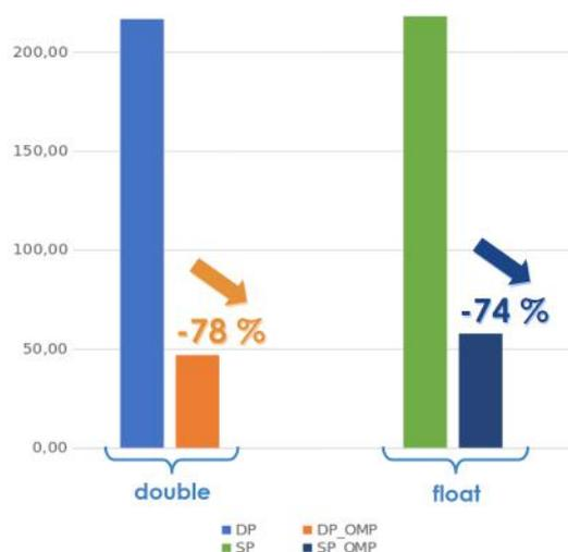
FIGURE 3.1 – Gain en temps d’exécution apporté par l’utilisation d’OpenMP<sup>2</sup>
