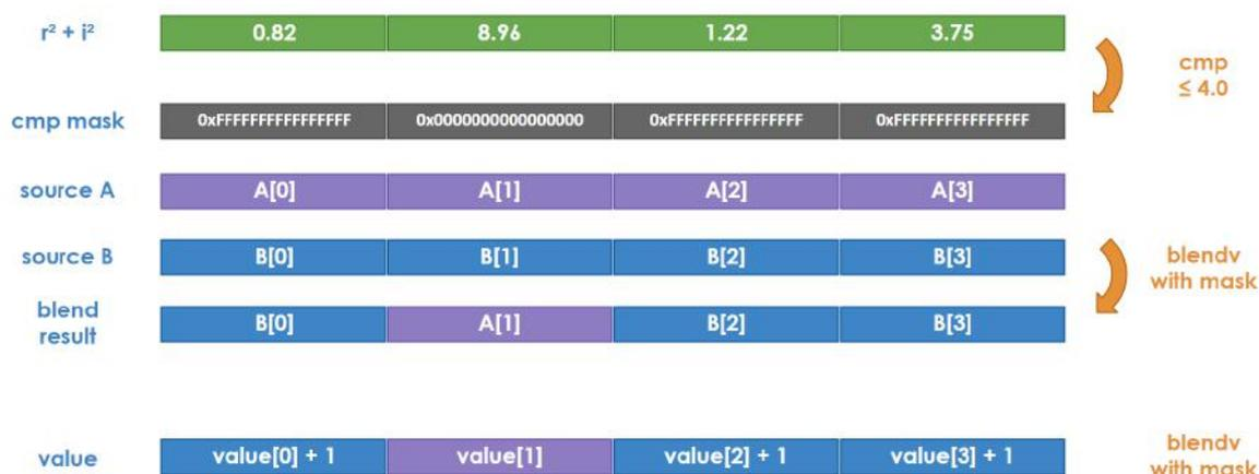
FIGURE 3.5 – Schématisation de l’incrémentation uniquement s’il n’y a pas eu convergence
