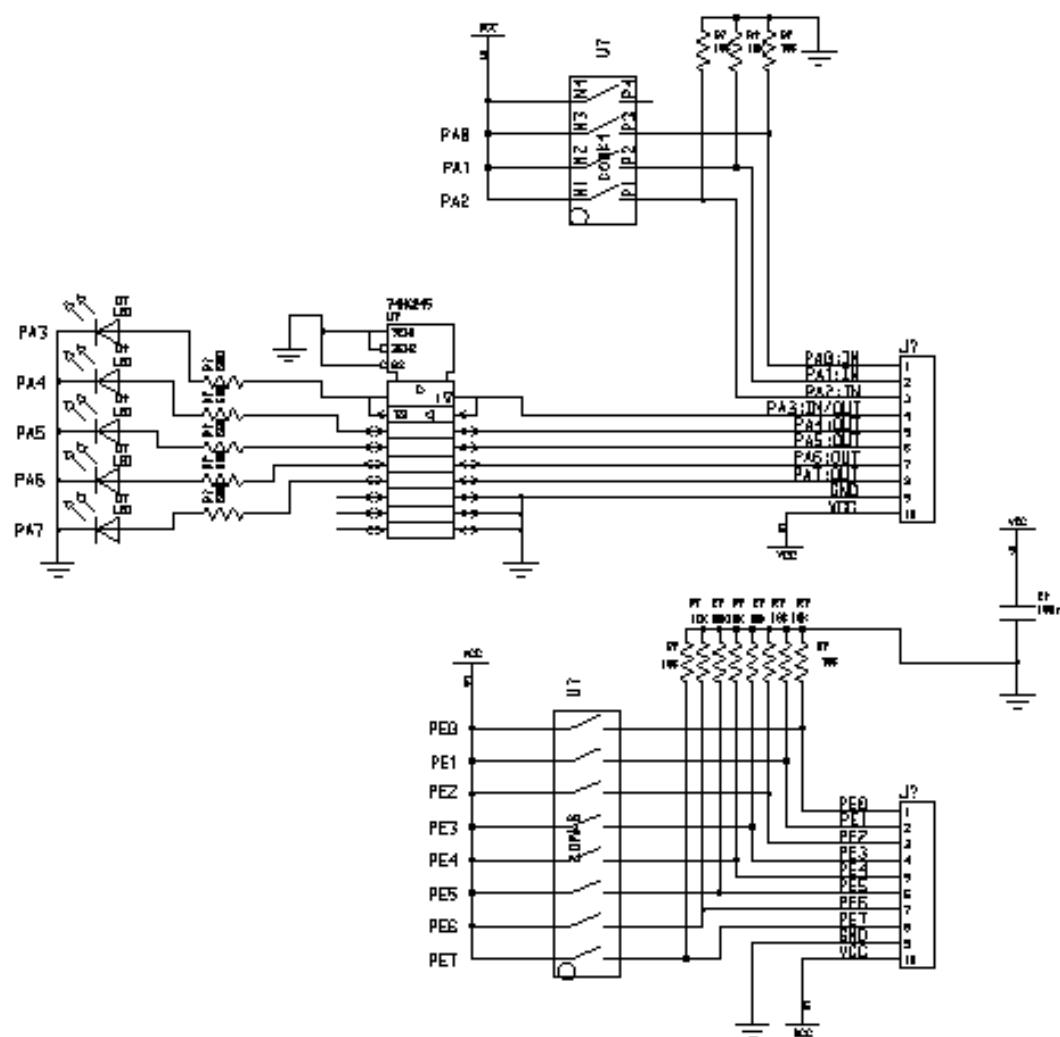
Figure 5 : Schéma électrique de la carte d'E/S
