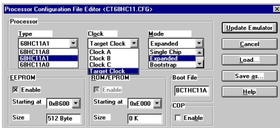
Figure 15 : Ecran de configuration de l'émulateur CT68HC11
