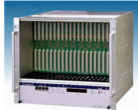
Carte au format VME ( Versa Module Eurocard )
