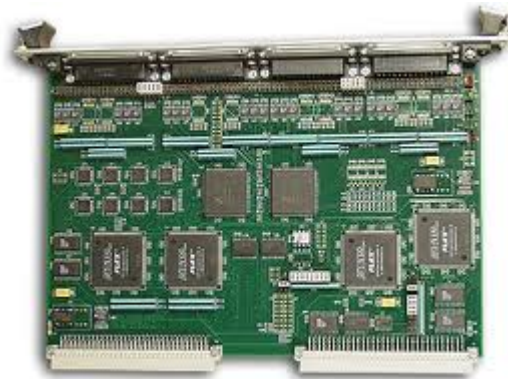
Carte au format VME ( Versa Module Eurocard )
