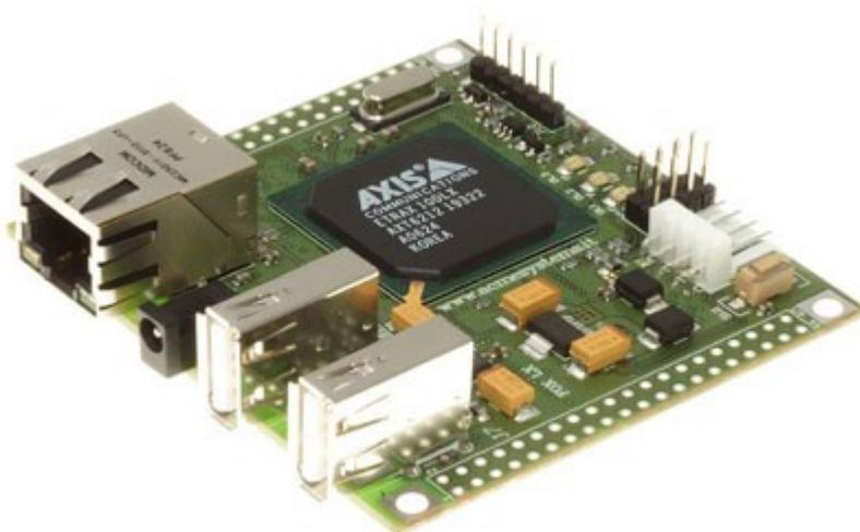
La carte Fox Board embarque un réel système d'exploitation Linux sur un processeur ETRAX 100LX. Ce processeur est basé sur une architecture RISC 100 MIPS fabriqué par la société AXIS (<http://developer.axis.com>).
